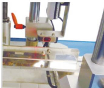
レーザーセンサーによる半打栓
