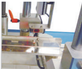
レーザーセンサーによる半打栓 及び中栓有無検知
