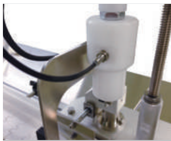
接触型の中栓有無検知
